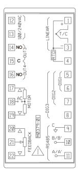
Fig. 3 REAR TERMINAL BLOCK
