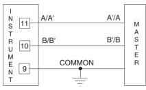
Fig. 11 - RS-485 WIRING
