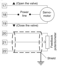
Fig. 8 - SERVOMOTOR WIRING
